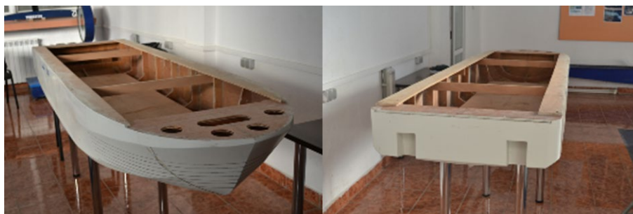
Figura 3.2. Model navă redus la scară. Scara 1:16. [78]
