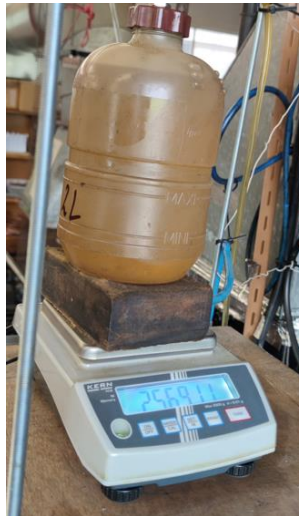
Figure 45 Măsurarea consumului de combustibil
