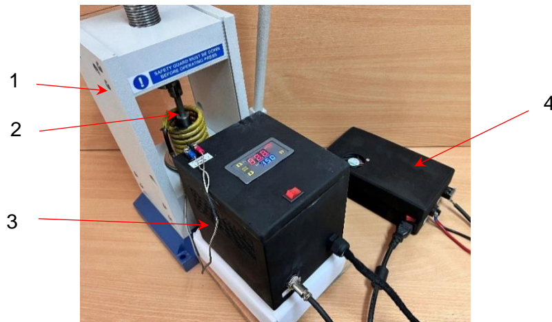
Figura 2.13. Echipamentul de presare la cald dezvoltat: 1 – presă hidraulică, 2 – matriță, 3 – dispozitiv de încălzire prin inducție, 4 – sursă de curent continuu
