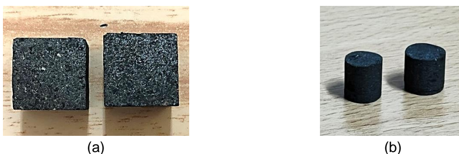
Figura 2.29. Probe din material de fricțiune comercial utilizate în cadrul determinărilor: (a) probe cu secțiune pătrată – pentru testele pe standul inerțial și (b) probe cilindrice pentru testele tribologice
