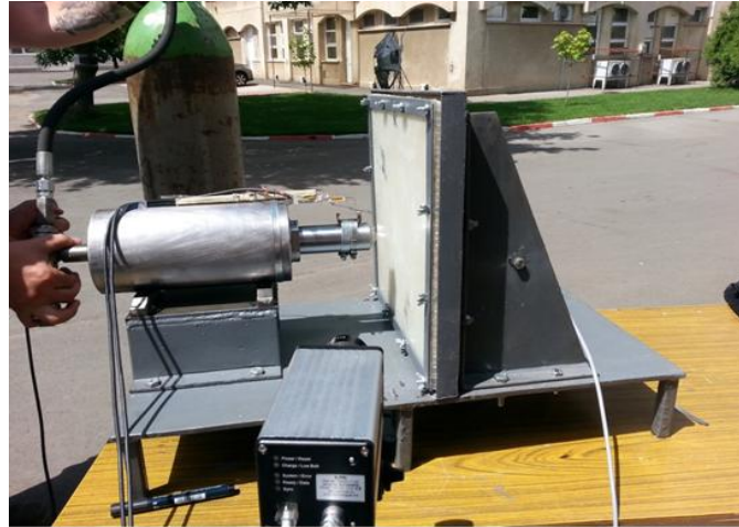
Figura 5.28 Stand pneumatic de încercări dinamice
