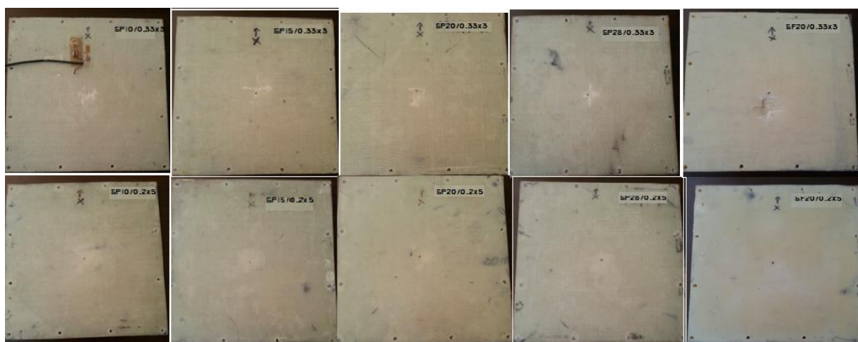
Figura 5.25 Imagini cu deteriorările plăcilor sandwich rezultate în urma impactului gravitațional cu cădere liberă
