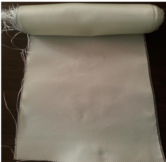
Figura 5.8 Tesătură Twill, grosime de 0,2mm
