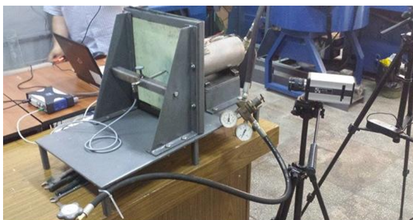
Figura 5.32 Măsurarea deformației maxime a plăcii
