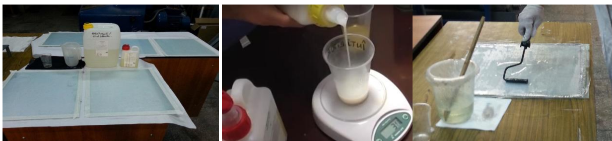
Figura 5.7 a) Pregătirea sticlei-suport pentru turnarea rășinii epoxidice, b) Cântărirea soluțiilor și împrăștierea rășinii epoxidice, c) Turnarea
