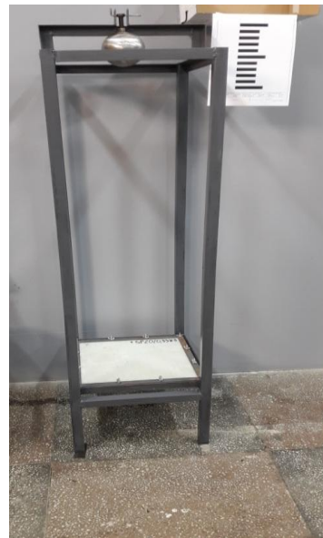
Figura 5.18 Standul de impact gravitațional, cu cădere liberă
