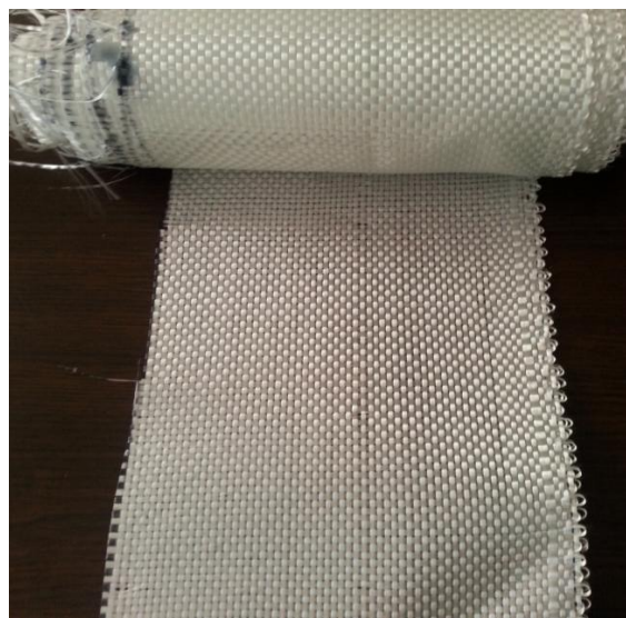
Figura 5.9 Tesătură cu grosime de 0,33mm
