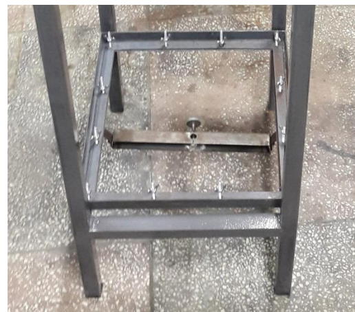
Figura 5.20 Standul pentru impact gravitațional. Cadrul cu suport pătrat
