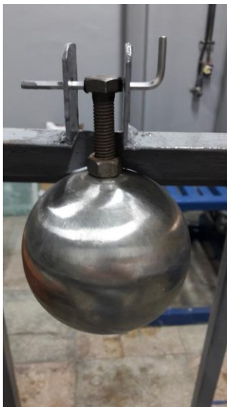
Figura 5.17 Impactorul cu masa de 5 [kg]
